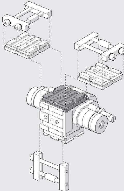
Così come per il piattello precedente, è possibile, svitando le quattro viti di fissaggio, ruotare di 90° il piattello rotante del sistema V-Lock, come mostrato nella figura seguente.
