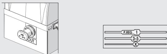
Applicando un silenziatore sulla bocca di scarico è possibile che le portate ed i tempi di risposta cambino. Verificare periodicamente l'intasamento del silenziatore ed eventualmente sostituirlo.
