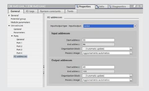
Configurazione S7 PCT Importare il file EB 80 IODD nel catalogo.
