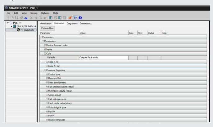
Stato uscite in sicurezza - Fail Safe Output
