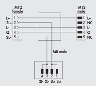
Può servire come alimentazione elettrica supplementare, quando il Master non ha sufficiente potenza, oppure per separare elettricamente l'alimentazione elettrica delle elettrovalvole all'apertura di una protezione della macchina, o alla pressione di un pulsante di emergenza.
