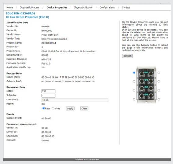
Nell'area Process Data viene visualizzato lo stato degli Input e degli Output.
