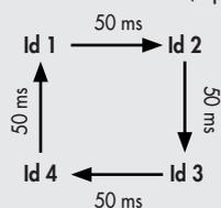
**Stato:** se i tempi rilevati si discostano da quelli impostati, oltre la tolleranza impostata nei campi "Tolleranza", si attivano i rispettivi bit di segnalazione. I bit di segnalazione si resettano al successivo rilevamento all'interno della tolleranza.
