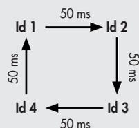
**Stato:** se i tempi rilevati si discostano da quelli impostati, oltre la tolleranza impostata nei campi "Tolleranza", si attivano i rispettivi bit di segnalazione. I bit di segnalazione si resettano al successivo rilevamento all'interno della tolleranza.
