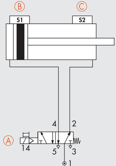
A = Valvola in uso 5/2 - valvola ad un pilota, posizione pilota su base per due piloti = 7
