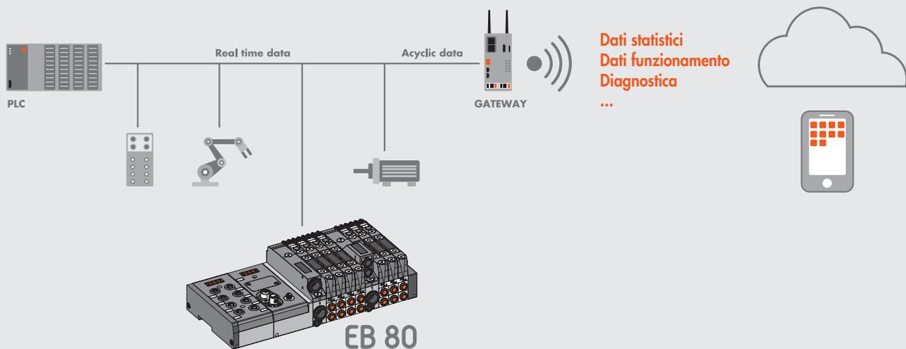
Le nuove funzioni di diagnostica avanzata di EB 80, denominate EB 80 I4.0, forniscono alla manutenzione tradizionale un potente strumento di analisi, per assicurare un esercizio affidabile, sicuro e duraturo delle unità produttive. Disponibili per tutte le Connessioni Elettriche con Bus di campo e basi identificate da scritta I4.0, integrano una diagnostica avanzata, in completa filosofia Industry 4.0.
