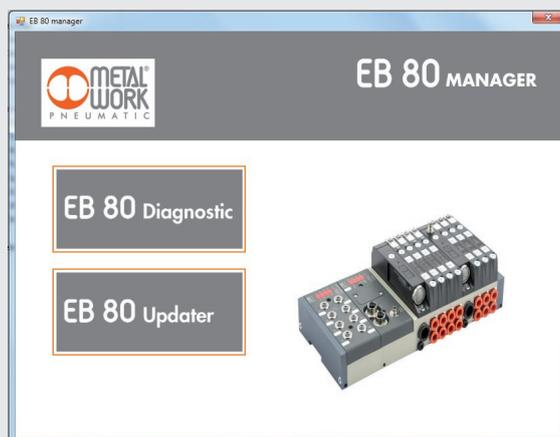
La connessione al Sistema EB 80 si effettua attraverso la porta USB, posta sotto il coperchietto del modulo Bus di Campo.
