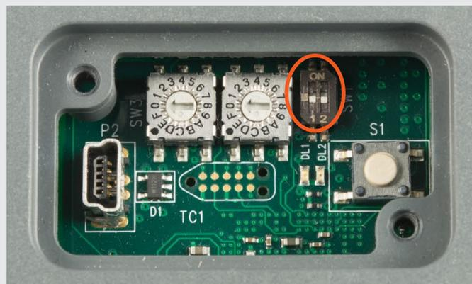
Connettere il modulo al PC tramite un cavo USB (USB tipo A – mini USB). Alimentare elettricamente il modulo.
